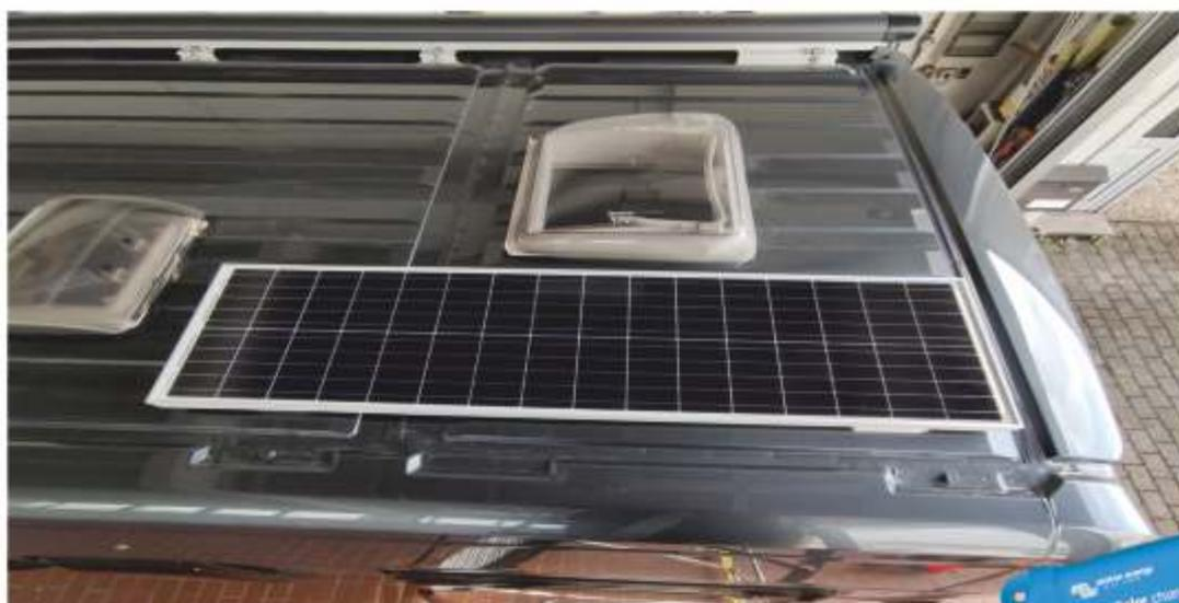
2 Solarmodule 80 Wp mit stabilem Aluminiumrahmen
